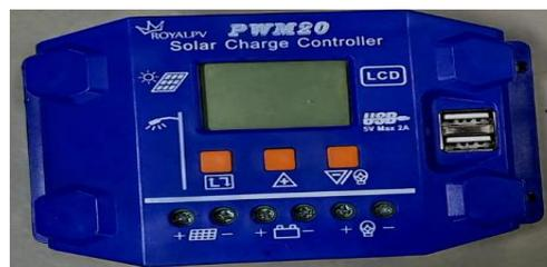
**Gambar 4.** Contoh pengontrol baterai
